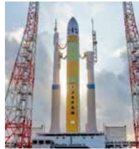
1 段実機型タンクステージ燃焼試験 (CFT) の際の H3 ロケット試験機1号機
