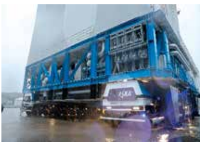
▲ 新型ドローリ（H3 ロケット試験機1号機極低温点検機体移動時）
