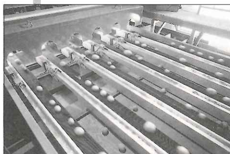
大きさをセンサーで区別して仕分けられる
